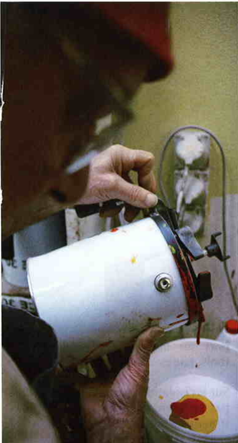
Mélange de peinture et teintage avec les pigments en pâte mouillée
