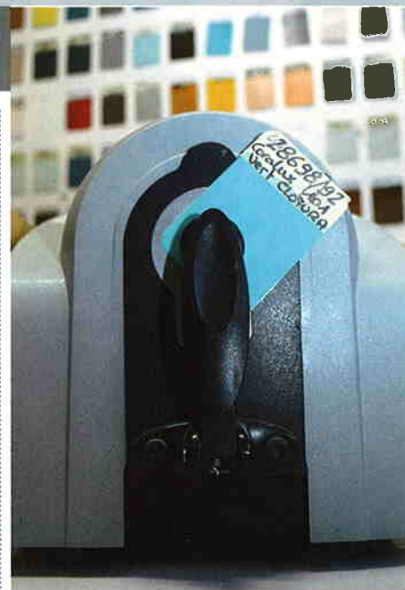
Les cartes de teintes RAL et NCS offrent un vaste choix. Ci-contre, un photospectromètre, qui permet de déterminer une teinte avec précision.
