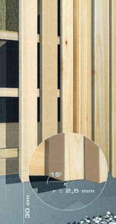
Angle pour goutte pendante, minimum 15 degrés
