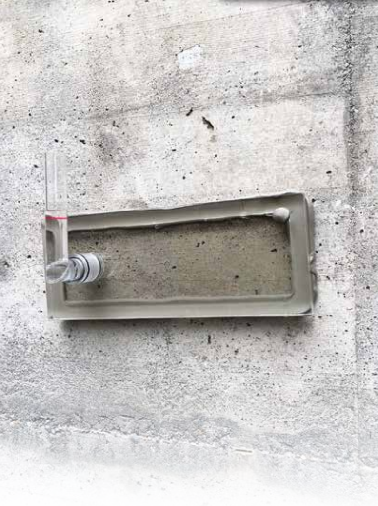
L'absorption d'eau de la façade en béton apparent a été mesurée par le calcul de physique du bâtiment. (© IABP)
