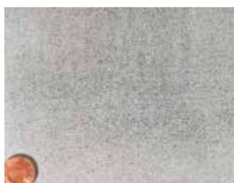
*Degré de pureté standard Sa 2.5. (À partir du degré de corrosion A.) La calamine, la rouille et les revêtements ont été éliminés, de sorte que les résidus ne sont visibles que sous forme de légères nuances dues à la coloration des pores.*
