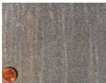
*Degré de pureté standard Sa 1 (À partir du degré de corrosion A.) La calamine et la rouille ne sont que partiellement éliminées.*
