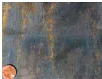
*Classe de corrosion A. Surface d'acier recouverte de calamine adhérente et pratiquement sans rouille.*
