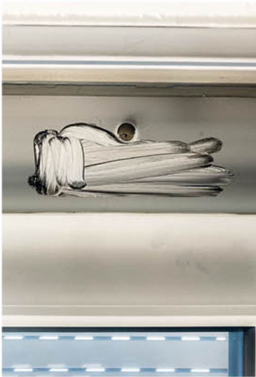
Test au diluant universel (nature de la peinture)
