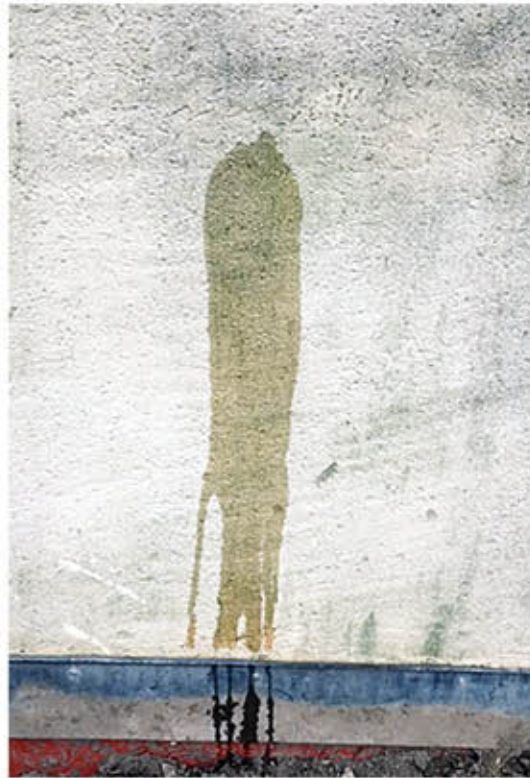
Test à l'eau (déterminer l'absorption du support)
